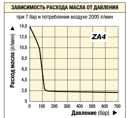
Насосы серии ZA4 с 9,8 – 19,8 – 39-литровыми резервуарами
