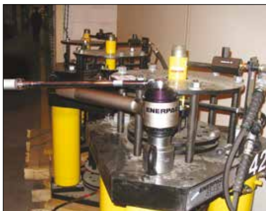
◀ Мультипликатора Enerpac E393 с опорной штангой используется для ручной закрутки болтов с моментом до 4300 Нм.
