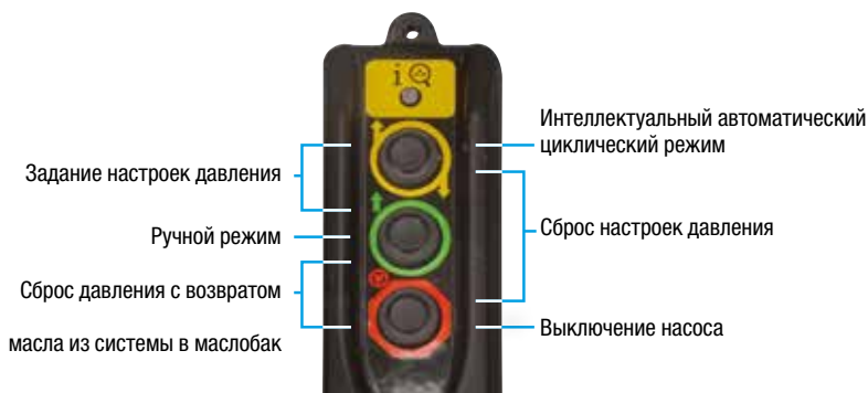
Пульт управления с 6-метровым проводом
