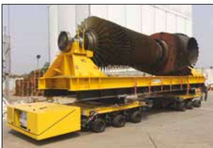
Транспортировка ротора турбины
