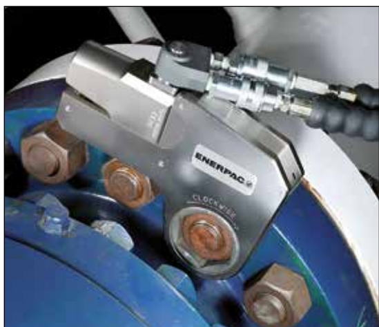
◀ Насосы для моментных ключей серии ZE4T отлично сочетаются с этим моментным ключом W2000X.
